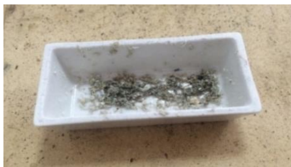
Рис. 2. Образовавшаяся зола после сжигания брикета из лузги подсолнуха
