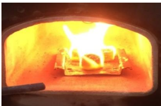
Рис. 4. Процесс горения топливных брикетов из лузги подсолнуха
