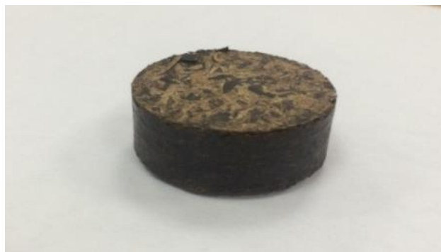
Рис.1. Брикет из лузги подсолнуха при \rho=250 кг·с/см 2
