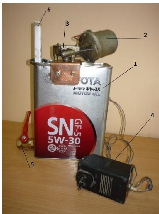
Рис 2. Прототип устройства для производства биодизельного топлива (1 – бак на 4 литра для процесса переэтерификации; 2 – электромотор мешалки; 3 – механические приводы мешалки; 4 – блок питания для мешалки; 5 – кран для слива глицерина и промывки готового биодизеля; 6 – термометр для контроля температуры)
