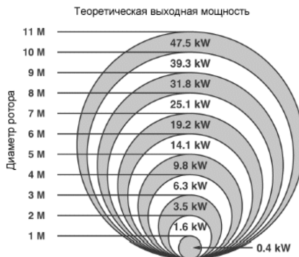
Рис. 2. Зависимость мощности ВЭУ от диаметра ротора
