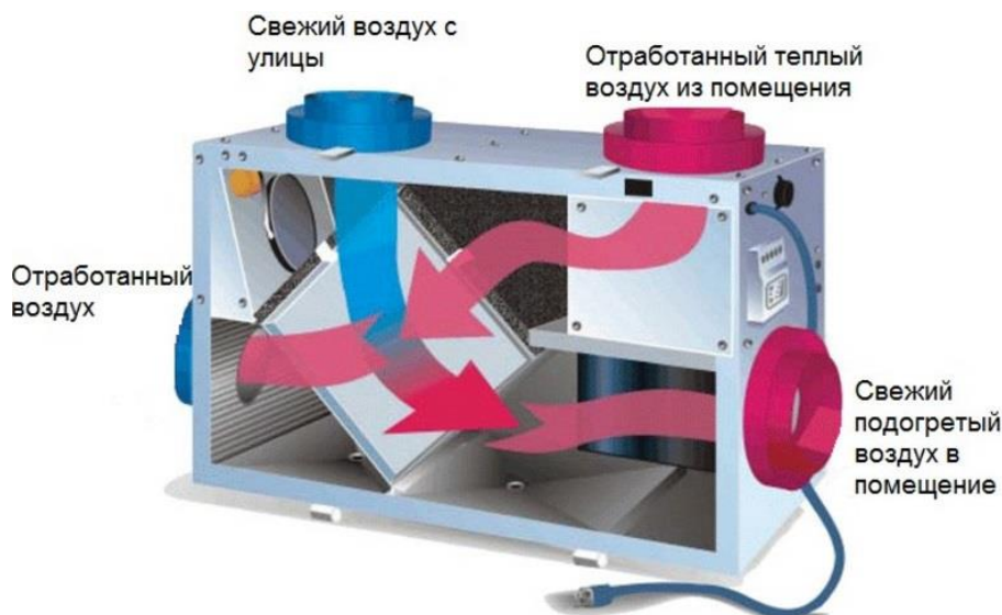
Рис. 2. Схема работы вентиляции с рекуперацией тепла
