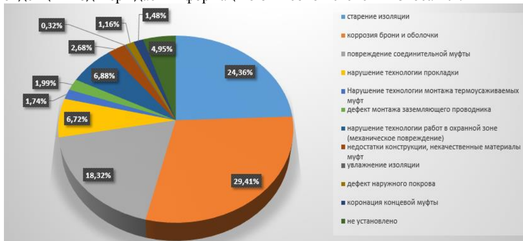
Рис. 1. Анализ причин выхода их строя кабельных линий
