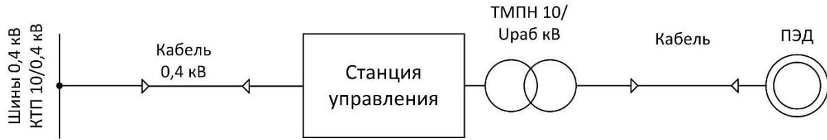
Рис. 1. Схема питания ПЭД
