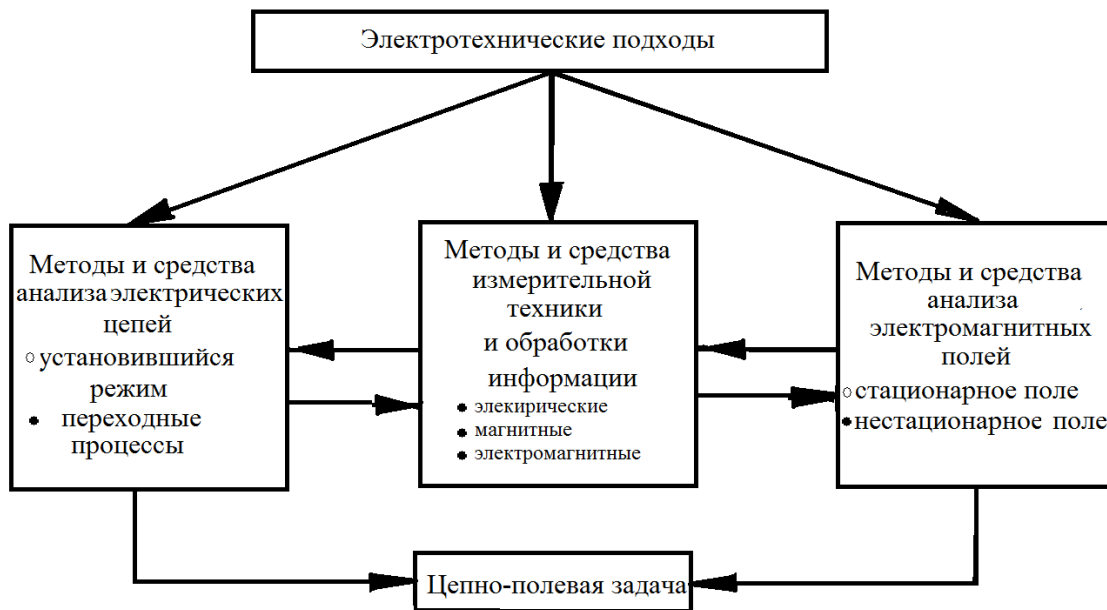
Рис. 1. Структурная схема электротехнических подходов к исследованию электроимпульсного эффекта очистки: О – Неиспользуемые позиции; ● – Рекомендуемые позиции к использованию
