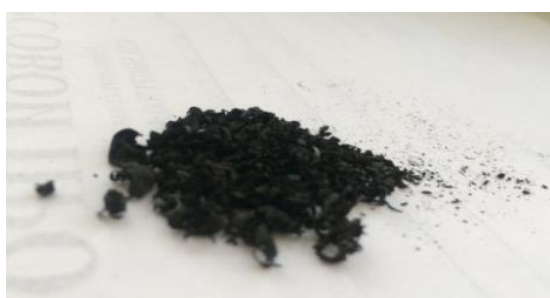
Рис.3. Остаток после выхода летучих брикета из лузги подсолнуха
